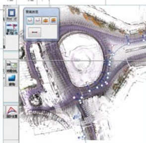
MMS 点群から路線・縦横断の作成
