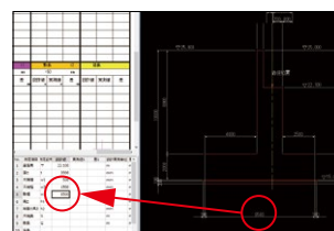
▲CAD図面から出来形帳票へ、マウス操作による設計値のワンタッチ入力
